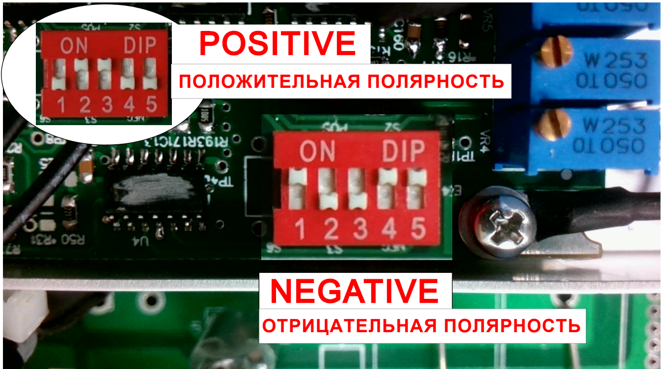
2.5.14 ПОЛОЖЕНИЯ DIP ПЕРЕКЛЮЧАТЕЛЕЛЕЙ ПЛАТЫ УПРАВЛЕНИЯ ПРИ СМЕНЕ ПОЛЯРНОСТИ
