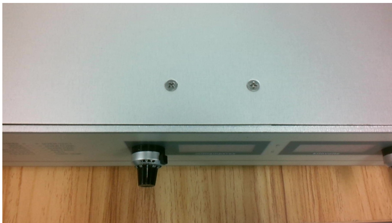
2.5.2 ДОСТУП К ДВУМ ДОПОЛНИТЕЛЬНЫМ ВИНТАМ ФИКСАЦИИ ВЕРХНЕЙ КРЫШКИ
